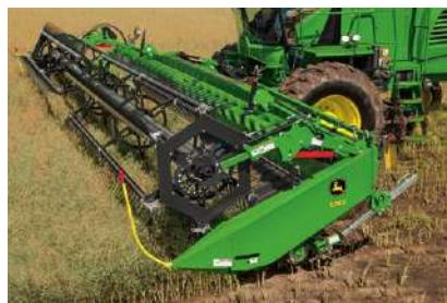
Привод лент от внутренней части полотна позволяют использовать дополнительный крутящий момент в сложных условиях, что обеспечивает постоянную производительность при уборке тяжелых или влажных культур.
