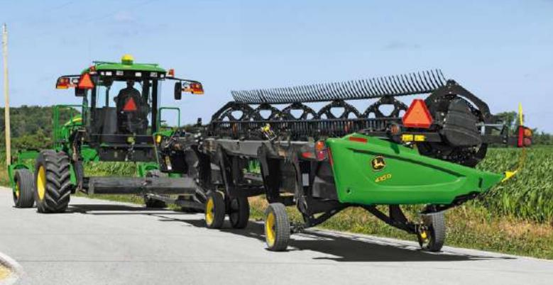
Модели ленточных жаток 430D, 435D и 440D могут быть оборудованы интегрированной системой транспортировки на низких скоротях. Один человек может с легкостью за несколько минут перевести жатку из полевого режима в режим транспортировки без каких-либо инструментов. Переднее спаренное колесо и два копирующих колеса несут весь вес жатки при транспортировке.
