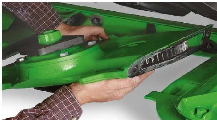
**ПРОСТОЙ ДЕМОНТАЖ МОДУЛЯ РЕЖУЩЕГО АППАРАТА**
