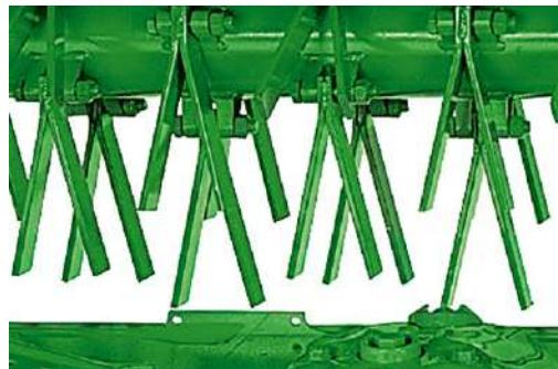
**ПРИ ПРАВИЛЬНОЙ РЕГУЛИРОВКЕ РОТОРНО-ПАЛЬЦЕВОЙ ПЛЮЩИЛКИ МОЖНО ЗНАЧИТЕЛЬНО СОКРАТИТЬ ВРЕМЯ СУШКИ. РАСПОЛОЖЕННЫЕ НА РАВНОМ РАССТОЯНИИ V-ОБРАЗНЫЕ ПАЛЬЦЫ УСТАНАВЛИВАЮТСЯ НА РОТОРЕ БОЛЬШОГО ДИАМЕТРА**
