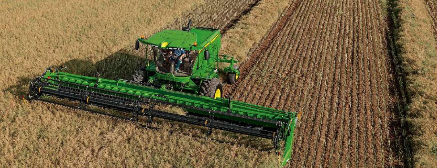
Самоходные косилки серии W200 совместимы с ленточными жатками 525D, 530D и 536D и роторными жатками 994, 995 и 500R.
