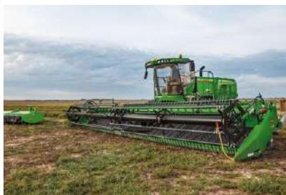
Чтобы снять роторную жатку и установить на косилку одну из ленточных жаток серии 500D, потребуется меньше 30 минут. Это значит, что можно выполнять уборку мелкозерновых культур и выполнять заготовку кормовых культур с помощью одной самоходной косилки.
