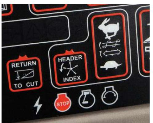
Система контроля скорости мотовила обеспечивает синхронизацию его скорости с ходовой скоростью косилки, позволяя оператору сосредоточиться на управлении жаткой, не отвлекаясь на регулировку скорости мотовила при изменении скорости уборки. Это гарантирует, что после включения системы, мотовило будет вращаться достаточно быстро и обеспечивать надлежащую подачу растительной массы.
