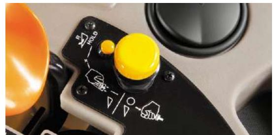
Опциональный механизм реверса жатки доступен для моделей W150. Расположенный перед кнопкой включения привода жатки, он легко приводится в действие с рабочего места оператора и обеспечивает очистку жатки от возможных забиваний.
