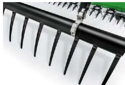
Быстрозаменяемые пальцы мотовила также позволяют экономить время. Если один из них выходит из строя, его можно снять и заменить с помощью минимального набора инструментов. И быстро вернуться к работе.
