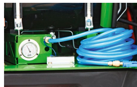
Предусмотрен шланг для очистки под высоким давлением
