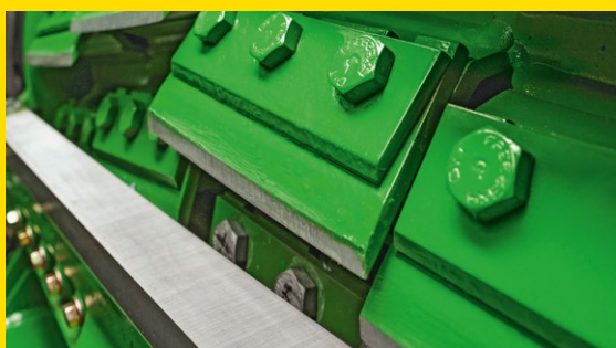
Противорежущий брус DuraLine Plus
