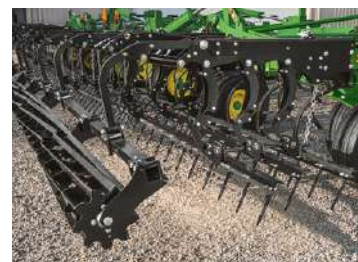
3-рядная зубовая борона с планчатым прикатывающим катком
