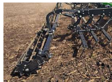
3-рядная штригельная борона с планчатым прикатывающим катком
