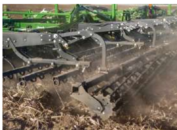
3-рядная штригельная борона с пружинным прикатывающим катком
