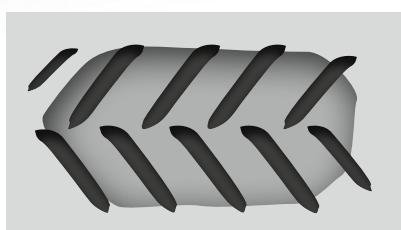
**Колесный трактор.** Меньшая поверхность соприкосновения с почвой и менее эффективное распределение веса приводят к немногому более высокому уплотнению грунта.
