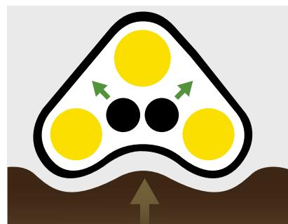
**Конструкция 9RX.** Инновационная конструкция 9RX с 2-мя промежуточными опорными роликами помогает рассеять вибрацию, отводя ее от моста и обеспечивая лучшую безопасность и комфорт при вождении.
