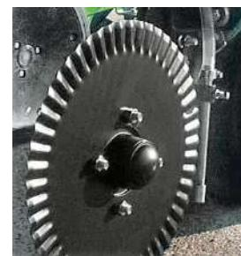
Устанавливаемый на высевающую секцию однодисковый сошник системы внесения жидких удобрений использует один 50-реберный рифленый дисковый нож для проникновения в твердый грунт. Жидкие удобрения вносятся в почву непосредственно за дисковым ножом.
