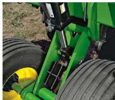
Большие копирующие боковых секций позволяют сеялке DB плавно перемещаться по поверхности почвы, а ширина колеи улучшает поток поживных остатков. В целях безопасности цилиндры крыла оборудованы блокировочными кронштейнами.
