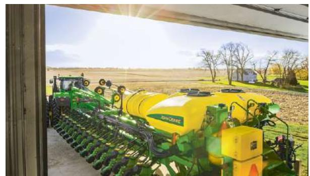
Могут ли сеялки точного высева шириной 11,2 и 36 м действительно складываться до приемлемой транспортной ширины? Не сомневайтесь! Фактически, конструкция со складывающейся вперед рамой серии DB при транспортировке имеет ширину от 4,5 до 5,3 м. Длина варьируется, но не превышает 158 см. Широкий просвет под рамой (56 и 76 см) во время транспортировки облегчает преодоление препятствий.
