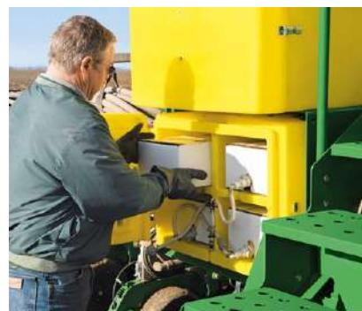
Центральная система внесения инсектицидов представляет собой революционную закрытую систему обработки, которая призвана эффективно бороться с повреждающими корни кукурузы личинками и обеспечить исключительную производительность сеялки точного высева.
