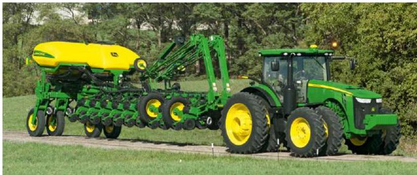
Перемещайтесь между полями, не беспокоясь о транспортировке. Даже с опциональной системой CCS сейлки точного высеяния 1775NT в транспортном режиме не превышают 3,7 м в ширину, так что пересечение мостов не является проблемой. Расположение баков системы CCS на раме было оптимизировано для достижения наилучшего распределения веса при работах в поле.
