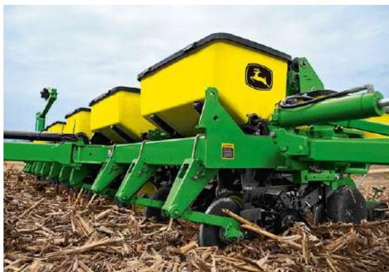
В каждый ящик для удобрений помещается около 250 кг гранулированных удобрений. Весь ящик поворачивается, облегчая сброс. Приводы и передачи входят в стандартную комплектацию. Выберите одну из 25 скоростей передачи в зависимости от используемого шнека.
