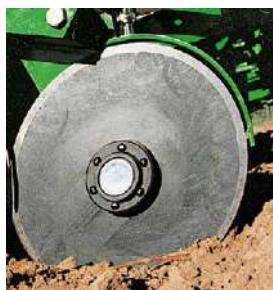
Устанавливаемые на высевающей секции двухдисковые сошники для жидких удобрений меньше разрушают почву. Удобрения могут быть внесены даже на глубину семян или ниже. Сошник может быть установлен на расстоянии до 5 и 7 см от ряда. Идеально подходит для полей, обработанных по традиционной технологии, требующих неглубокой обработки и легких необработанных полей.
