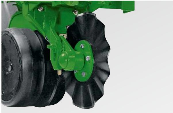
Дисковые ножи работают за счет массы сеялки и используют ее способность копировать рельеф при работе на полях, обработанных по минимальной технологии.
