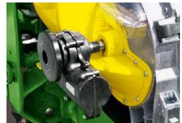
Система RowCommand управляет подачей семян с помощью муфты внутри каждого редуктора привода Pro-Shaft. Более прочный корпус создает защиту от препятствий и обеспечивает продолжительную работу без поломок.
