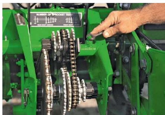
Прицепная сеялка 1755 оборудована простой цепным приводом подачи семян, который позволяет легко и быстро изменять скорость. Выберите одну из 50 скоростей посадки.
