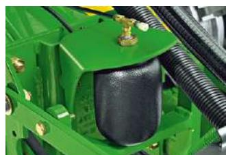
Пневматическая прижимная система позволяет регулировать прижимное усилие в соответствии с рабочими условиями.
