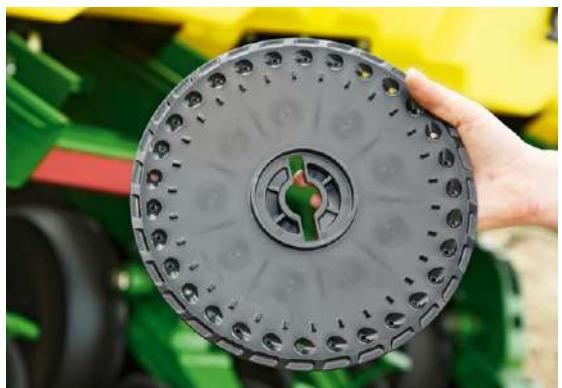
Вакуумный дозатор семян всасывает и удерживает отдельные семена в отверстиях высевающего диска, контролируя плотность и точность посева. Таким образом, скорость может быстро изменяться, а операторы могут выбирать из 50 различных скоростей посева.
