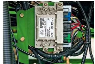
Этот электронный блок питания — сердце системы RowCommand. Низковольтные сигналы по шине CAN контролируют подачу сигнала на нужный привод Pro-Shaft. Кроме того, система имеет функцию защиты от ошибки: при отказе муфты дозатор продолжает высев.
