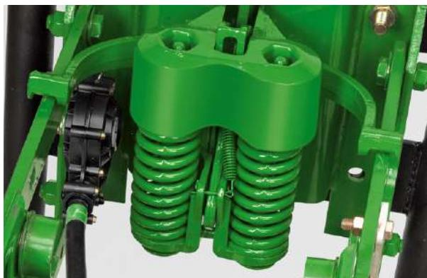
Регулируемые усиленные прижимные пружины (слева) позволяют устраниить подпрыгивание высевающих секций на полях с большим количеством пожнивных остатков или на твердой почве. Прижимное усилие можно регулировать в четырёх положениях – 0, 57, 114 или 182 кг на каждую высевающую секцию. Для изменения настроек специальных инструментов не требуется.
