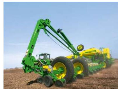
Телескопическая навеска позволяет подсоединять 1775NT ближе к трактору, что обеспечивает дополнительную маневренность. Складывающиеся втрое маркеры входят в стандартную комплектацию 12- и 16-рядных моделей; складные маркеры стандартно устанавливаются на 24-рядные модели 1775NT.
